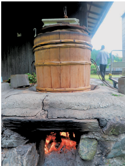
石造りのクド（煙突なし、燃料は薪）
