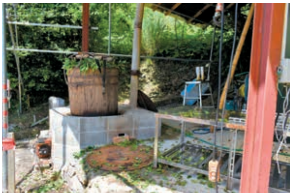
③ コンクリートブロック造りのクド（煙突あり、燃料は石油）
