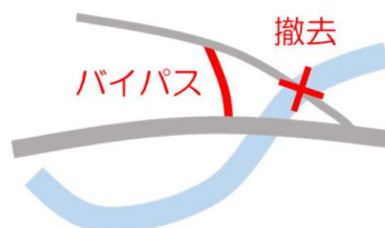
【撤去+バイパス整備】
